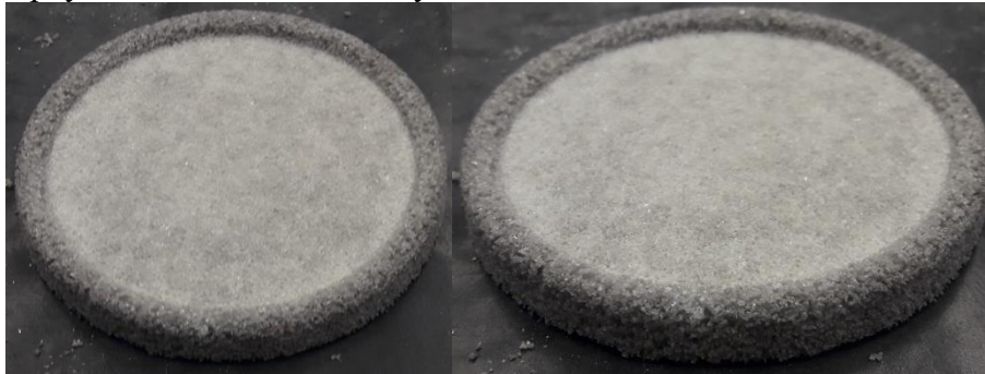
Obr. 9 Sintrované vzorky tvaru medaile vyrobené z recyklátu – Glassticine REcycled
